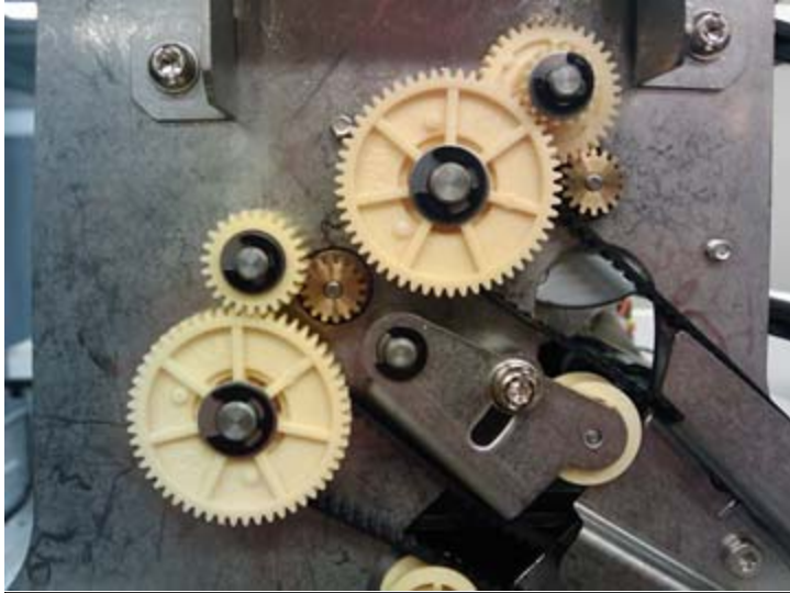
Foto: Engrenagens de plástico feitas com os compostos especiais LNP* da SABIC Innovative Plastics
